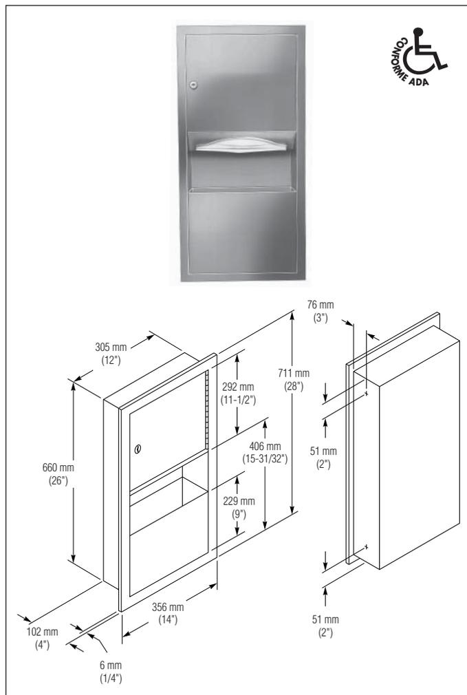
longueur et serrure à gorge. Capacité de distributeur d'essuie-mains de 475 essuie-mains enchevêtrés ou 350 essuie-mains en C. Réceptacle de déchets en acier inoxydable amovible de 8 litres (2 gallons).
