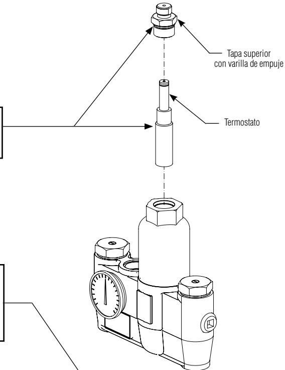
**B** Inserte una varilla de 8 mm de diámetro en la válvula hasta que toque la parte superior de la varilla de empuje que está adherida al pistón. Marque la longitud de la varilla dentro de la válvula. Empuje la varilla hasta que se detenga el pistón y marque la nueva longitud.
