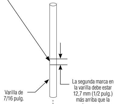
**D** Empuje el mecanismo hacia arriba y hacia abajo varias veces para asegurarse de que el pistón se mueva suave y constantemente. Si es constante, repita el Procedimiento C hasta que se mueva libremente o cámbielo. Comuníquese con el representante local de Bradley y consulte por el Kit del pistón y revestimientos (número de pieza S65-413).
